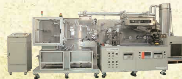
TH-C型セパレータ塗布用溶剤回収塔付き
