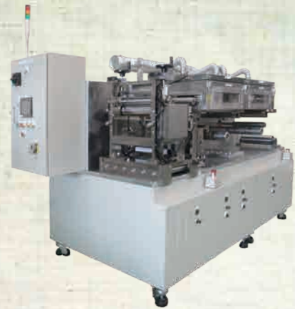
2本ロール乾燥炉1m x 2炉タイプ
