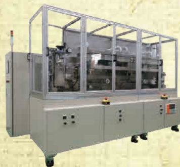
3本ロール乾燥炉1m x 2炉タイプ囲い付き
