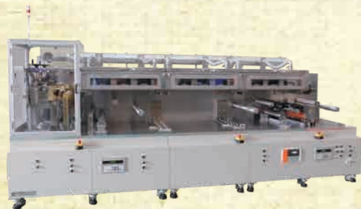
3本ロール乾燥炉1m x 3炉タイプ
